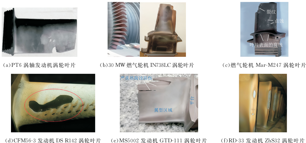
图1 高温腐蚀失效涡轮叶片 [2]
